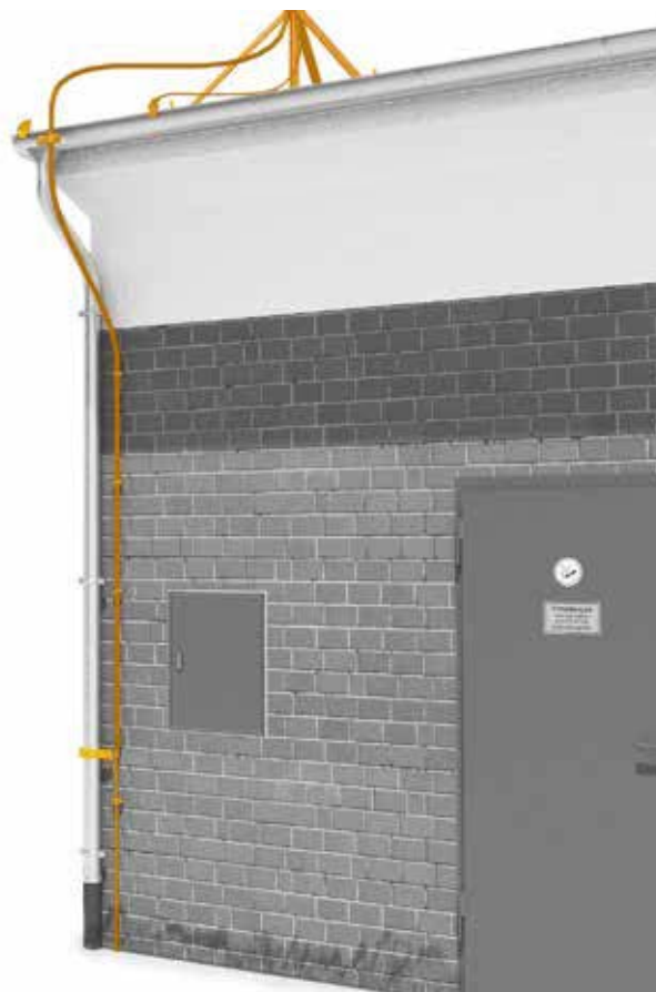
Рис. 2.56: Пример: защита газовой разводки посредством провода isCon®
