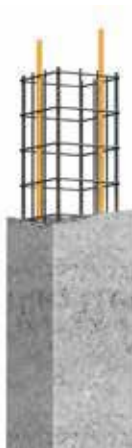
Рис. 2.53: Пример: Использование арматурных бетонных опор / молниеотвода
