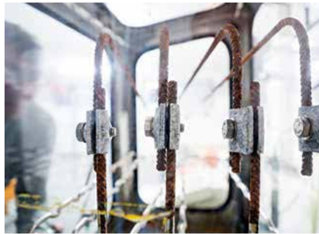
Рис. 1.26: Испытательная установка ВЕТ-SO
