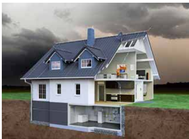
Рис. 3.22: Дом с молниевотводом и системой внутренней молниезащиты
