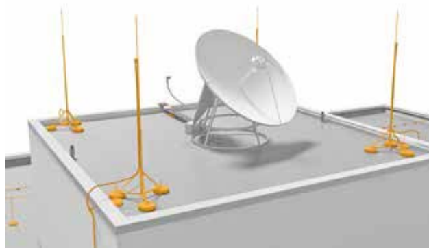
Рис. 2.61: Разделенная молниезащита с молниеприемными стержнями
