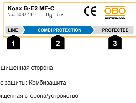
Рис. 3.60: LPZ 0 B - 3, Конечный идентификатор C (комбинированная защита, комбизащита) выделен синим цветом
