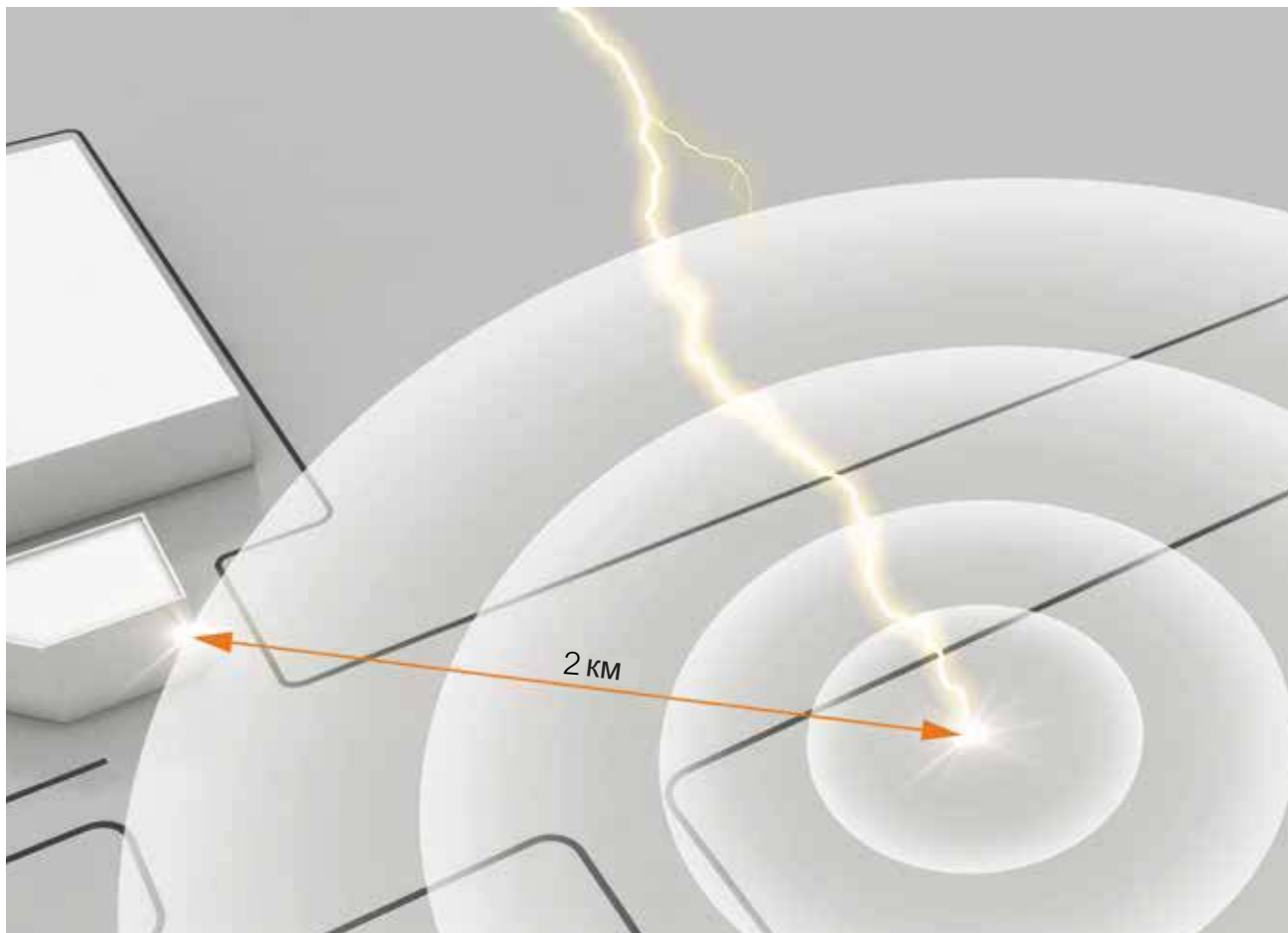
Рис. 1.12: Угроза: Импульс перенапряжения в результате индуктивного и гальванического ввода
