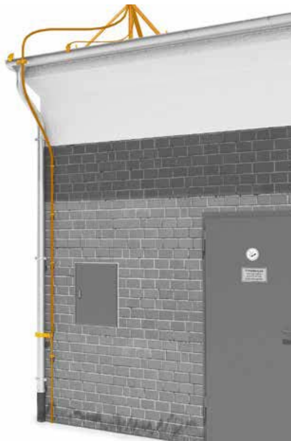
Рис. 2.56: Пример: защита газовой разводки посредством провода isCon®
