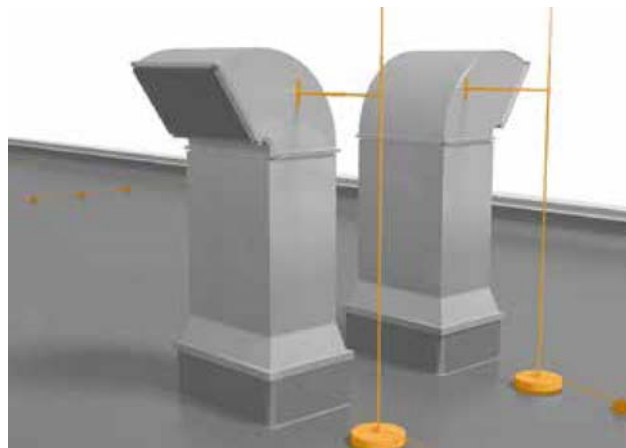
Рис. 2.31: Молниеприемный стержень с регулируемой изолированной траверсой
