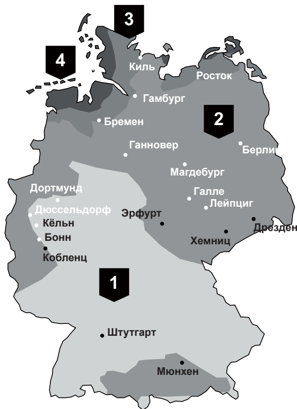
Рис. 2.21: Зоны ветров в Германии в соответствии с DIN EN 1991-1-4 NA
