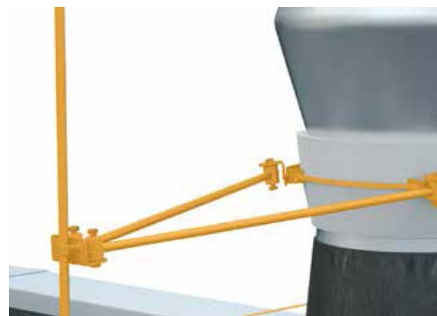
Рис. 2.35: Пример: молниеприемная система с комплектом Iso-Combi для V-образного трубного крепления
