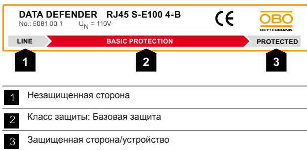
Рис. 3.59: LPZ 0 B - 2, Конечный идентификатор B (базовая защита) выделен красным цветом
