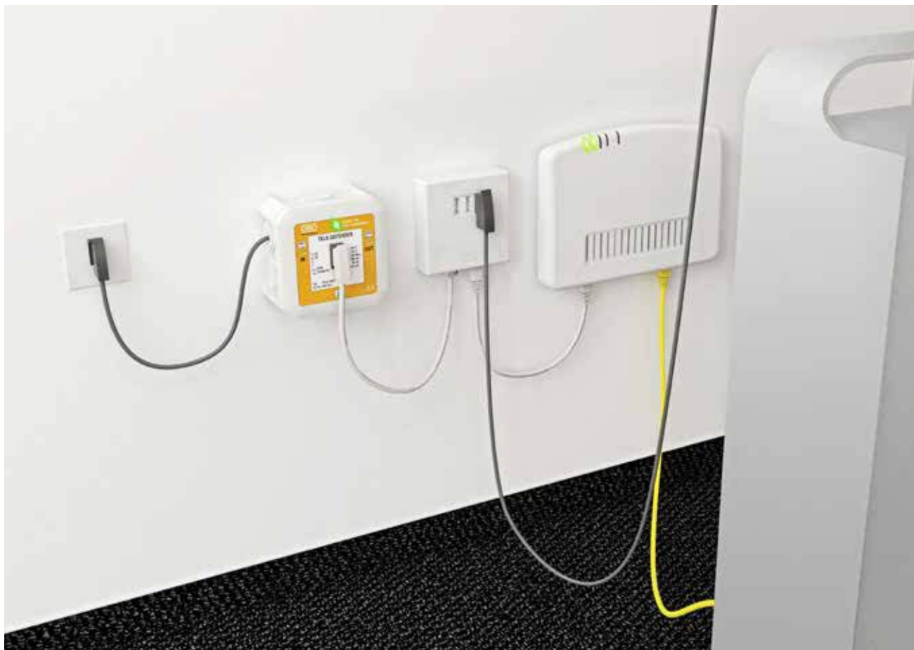
Рис. 3.69: Защита подключения ISDN + DSL при помощи TeleDefender
