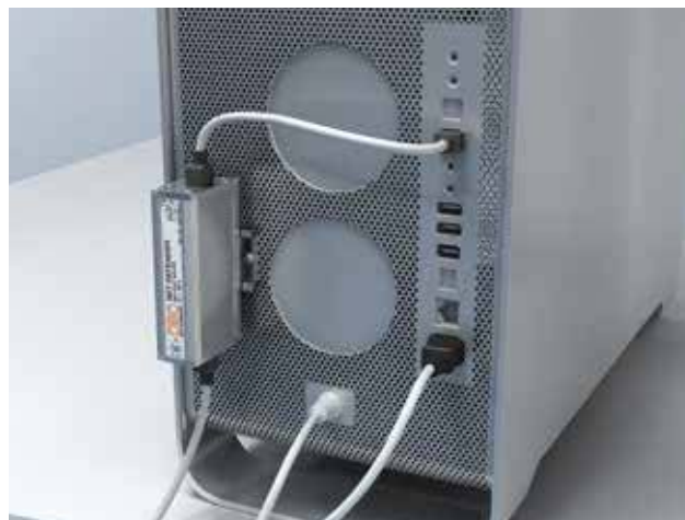
Рис. 3.82 Рекомендация по защите на оконечном устройстве.
