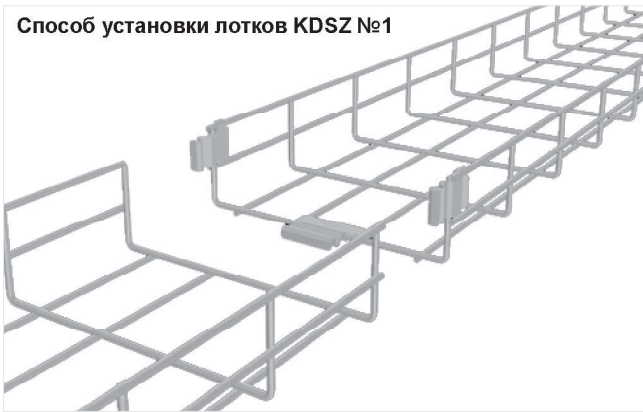
Вставить соединитель одного лотка между проволокой в бортике второго лотка
