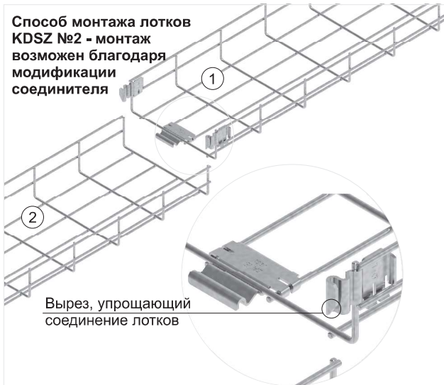
Прочное соединение лотков KDSZ... с помощью защелки.
