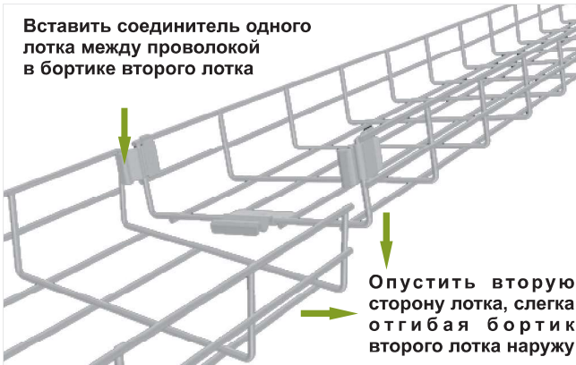
Способ монтажа лотков KDSZ №2 - монтаж возможен благодаря модификации соединителя
