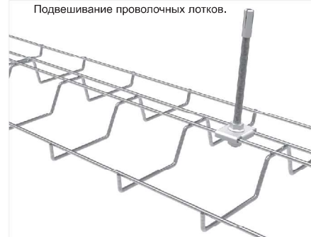
Подвешивание проволочных лотков.
